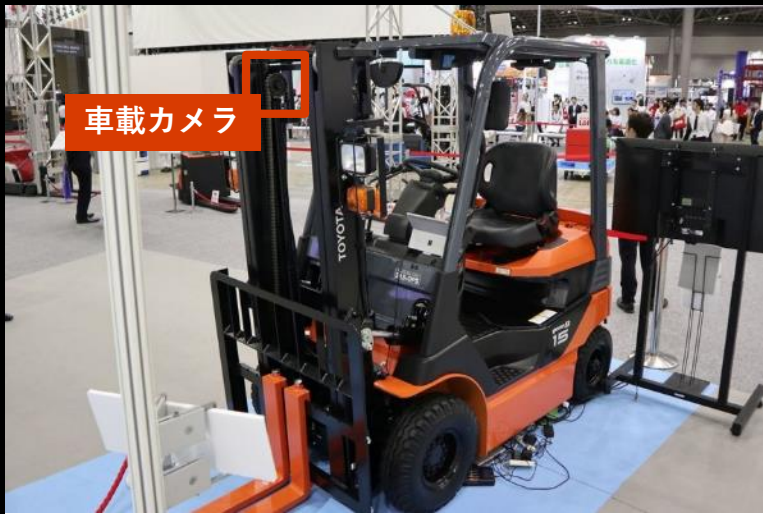
フォークリフト前方に取り付けられたカメラの画像を、AIが常時監視
