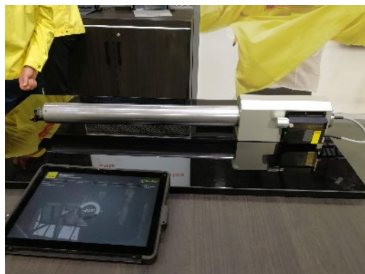
工作機械用ドリルセンサーデータウェイ上で推論を実行、リアルタイムに数値判定し、データ解析からアルゴリズム開発 (熱・振動・取付軸角度)
